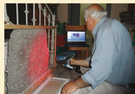
4. Rilievo con *laser scanner* del cippo terminale EE VIII, 732. (Archivio Laboratorio di Epigrafia per l'Archeologia)
